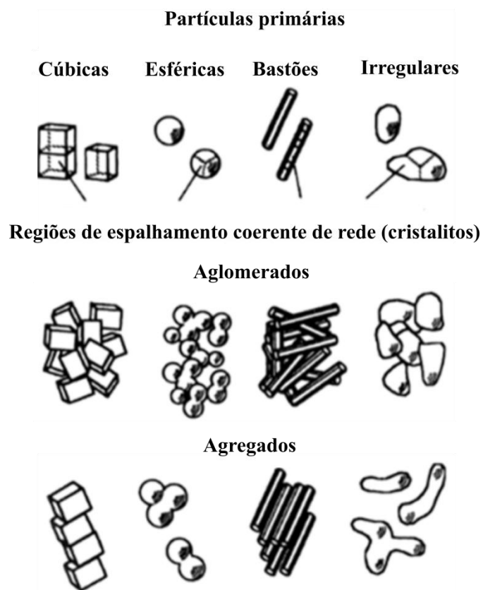
Figura 2 - Partículas primárias, aglomerados e agregados
